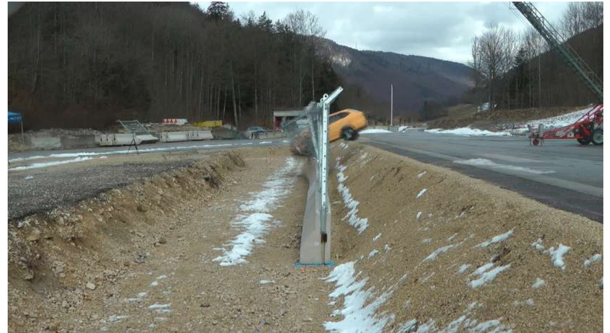
車両重量1'000kg、速度120km/h、角度20度
