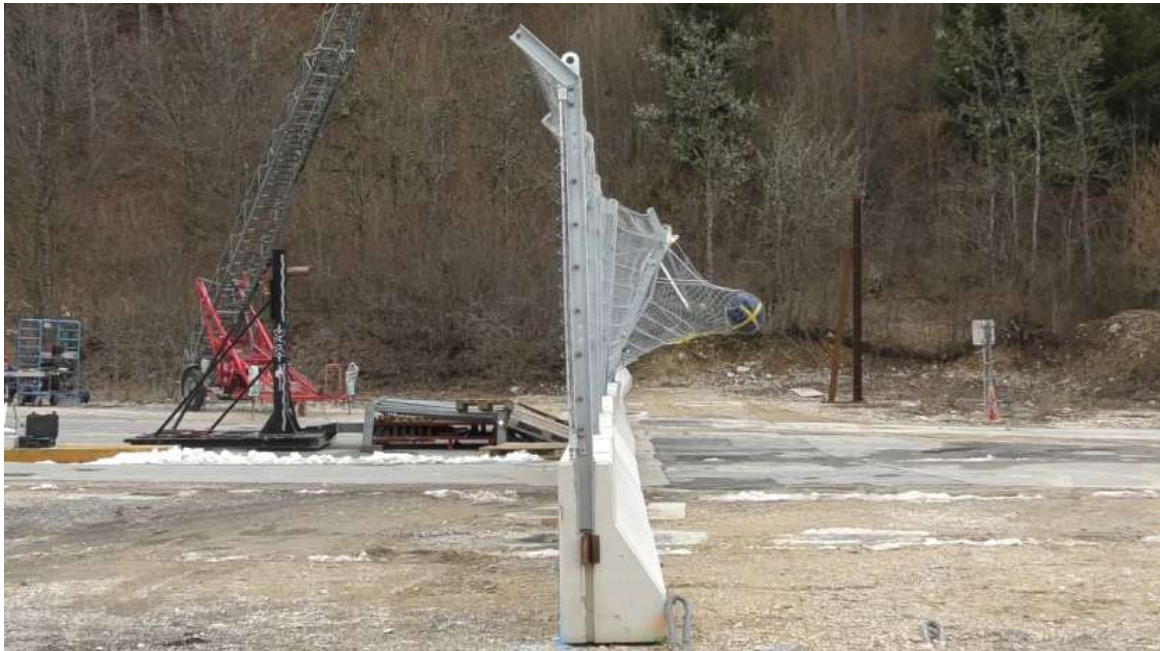
重錘重量780kg、速度62km/h、角度90度
