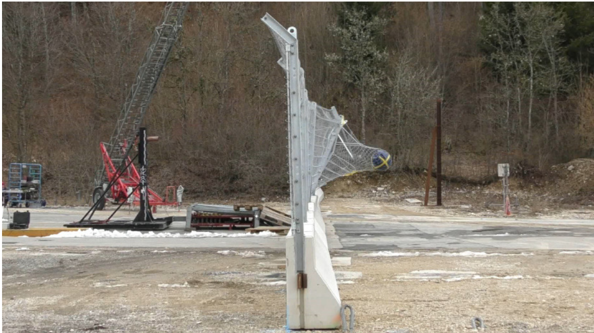
重錘重量780kg、速度62km/h、角度90度
