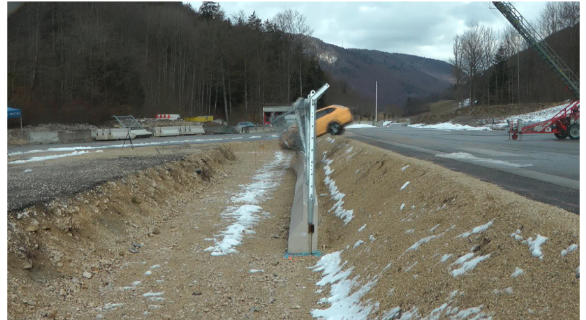
車両重量1'000kg、速度120km/h、角度20度
